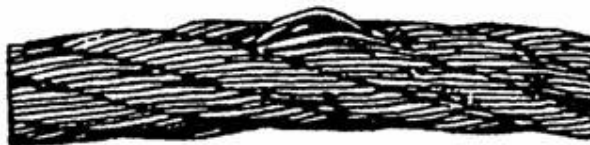
Рис. 10. Выдавливание сердечника
