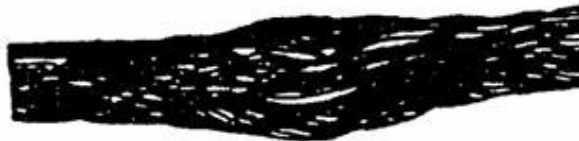
Рис. 12. Местное увеличение диаметра каната
