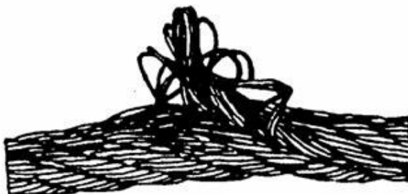
Рис. 10. Выдавливание сердечника
