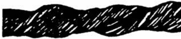
Рис. 6. Местное уменьшение диаметра каната на месте разрушения органического сердечника
