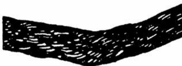
Рис. 15. Залом каната
