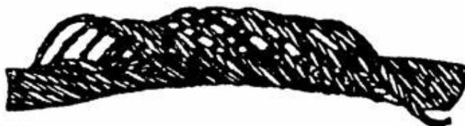
Рис. 9. Корзинообразная деформация
