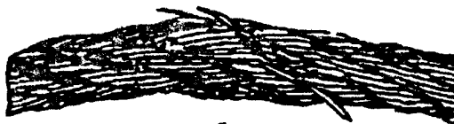
Рис. 2. Сочетание обрывов проволок с их износом:
