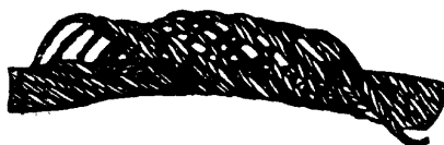
Рис. 9. Корзинообразная деформация
