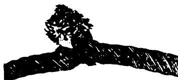
Рис. 14. Перекручивание каната
