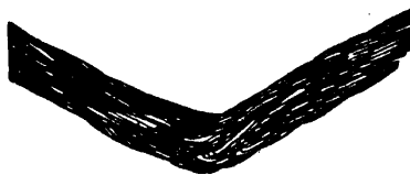
Рис. 16. Перегиб каната
