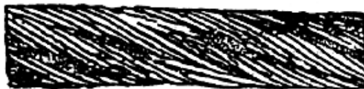
Рис. 2. Сочетание обрывов проволок с их износом:
