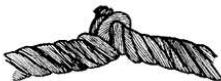
Рисунок 15. Перекручивание каната
