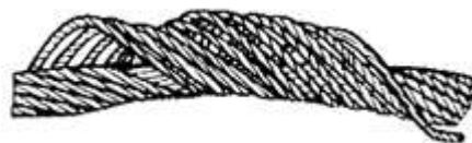
Рисунок 10. Корзинообразная деформация
