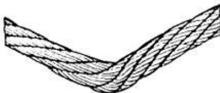
Рисунок 17. Перегиб каната
